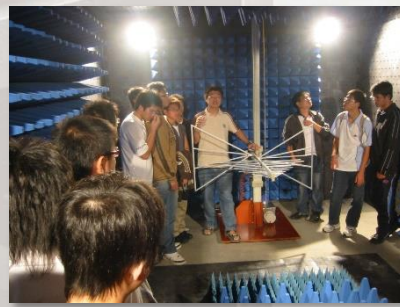
電波隔離暗室
